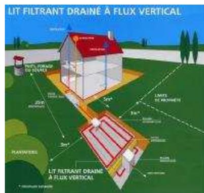
3. Le lit filtrant drainé à flux vertical : à la différence du dispositif n°2, les effluents sont drainés après traitement afin d'être évacués hors de la parcelle
