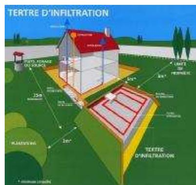
4. Le tertre d'infiltration : la nappe phréatique étant trop proche, le système de traitement reconstitué est réhaussé d'environ 80 cm au-dessus du sol
